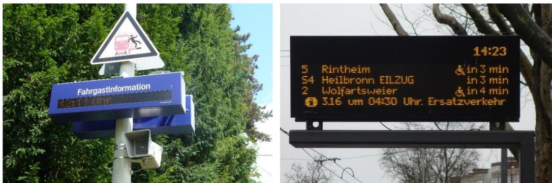
Abbildung 32: Digitale Fahrgastinformation an S-Bahnstationen (Bestand) und an Bushaltestellen (Möglichkeit)
