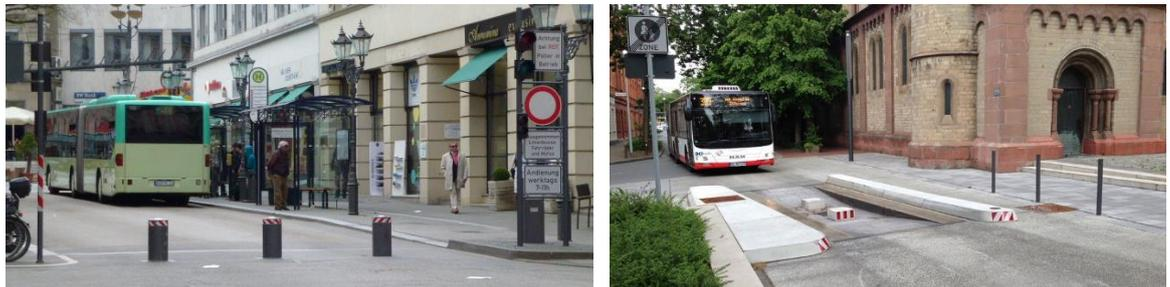
Abbildung 29: Beispiel von Busbeschleunigung durch Busschleusen Baden-Baden und Bochum
