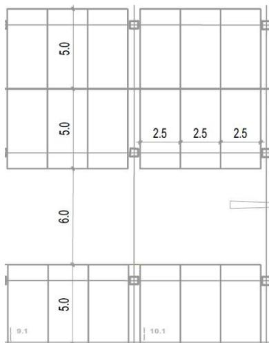
Abbildung 10 Abmessungen Parkfelder und Fahrgassen
